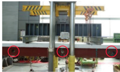
▲ 설비 구멍이 있는 BESTOBEAM 휨테스트
